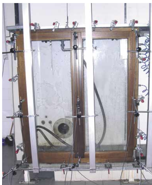
Prova di resistenza al carico del vento
