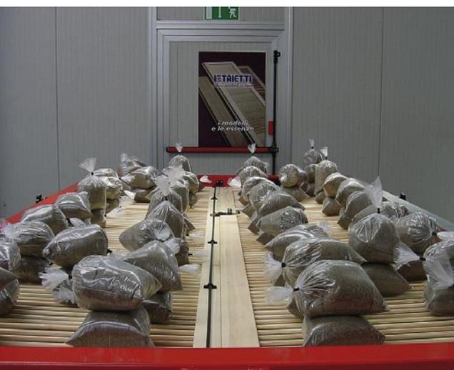
La prova di resistenza al vento viene effettuata con dei pesi distribuiti sulla persiana (sopra), una volta sulla faccia esterna (simulazione di carico di vento in pressione, fig.1), una volta sulla faccia interna (simulazione di carico di vento in depressione, fig.2).
