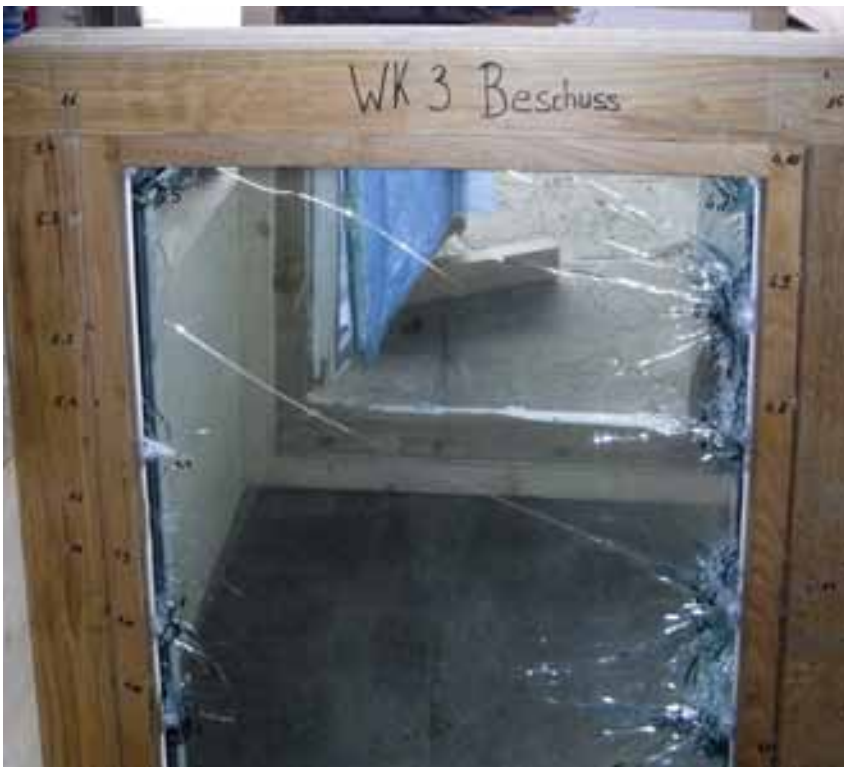
Durante la prova sulla finestra antiproiettile (classe di resistenza 3), un fucile ha sparato lungo la giunzione tra vetro e legno, la zona più vulnerabile
