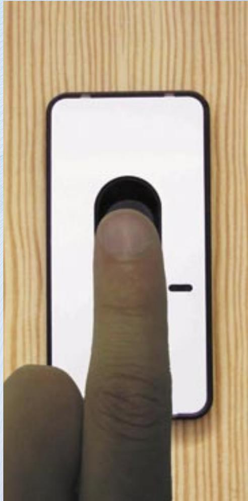
*Unità esterna: un piccolo scanner incassato nel serramento riconosce l'impronta digitale, diversa da individuo a individuo*
