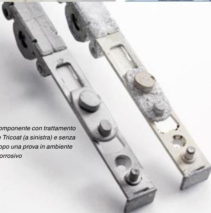
*La stessa componente con trattamento di superficie Tricoat (a sinistra) e senza (a destra) dopo una prova in ambiente altamente corrosivo*
