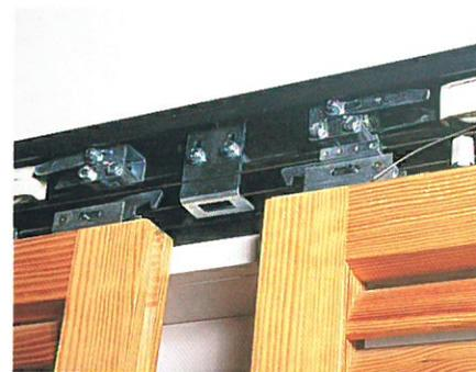
La novità consiste comunque nel **blocco di sicurezza**. Il dispositivo realizzato quasi completamente in acciaio inox, rende praticamente impossibile l'apertura forzata delle persiane dall'esterno. Il dispositivo essendo collegato con il cavo di trazione, aziona i ganci che si sollevano e vanno ad incastrarsi nell'apposito blocco. Il dispositivo di sicurezza è ambidestro in esecuzione per una o due ante. Nell'eventualità di mancata tensione è possibile lo sbloccaggio manuale dall'interno.
