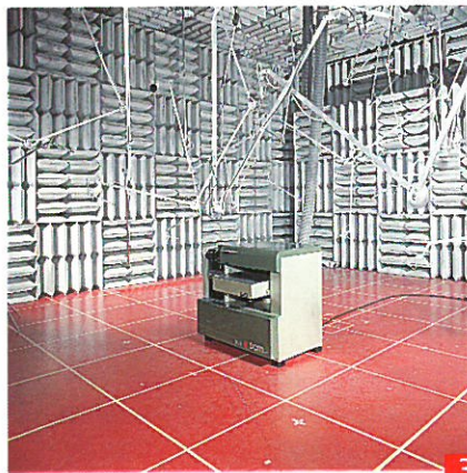
Foto 3: Sala semianecoica per la rilevazione delle emissioni sonore.
