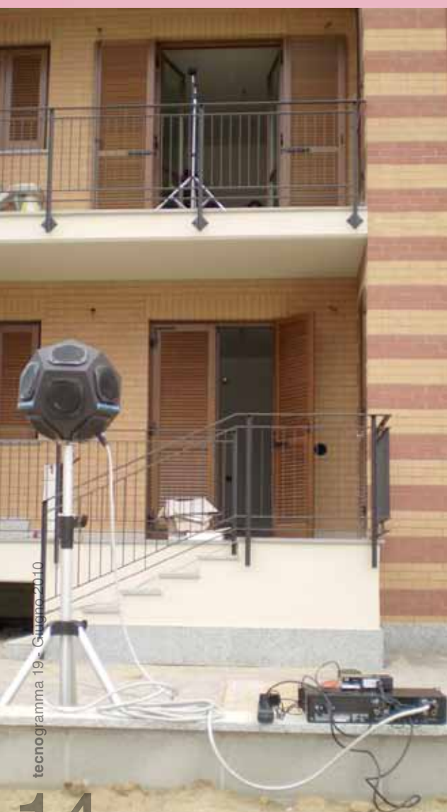
Un tecnico specializzato misura l'abbattimento acustico del tetto
