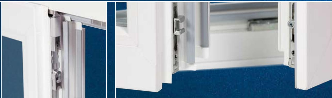
Per aprire a ribalta entrambe le ante è sufficiente ruotare un piccolo scontro che si trova sulla seconda anta. In questo modo, aprendo a ribalta la prima anta, un fungo autoregolante si inserisce nello scontro e porta con sé anche la seconda anta. Il nuovo sistema d'apertura a doppia ribalta si può applicare solo su finestre con ante fino a 60 chili di peso, per un'altezza massima di 1.590 mm.
