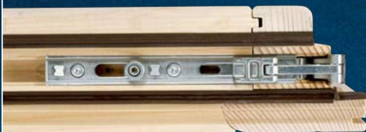
Sulla seconda anta, in alternativa all'asta leva, è possibile montare due catenacci. Anche a chi sceglie questa soluzione, Multi-Matic garantisce sicurezza antiscasso: i catenacci non lavorano con uscite a puntale bensì con un fungo autoregolante sul lato inferiore e, sul nodo centrale, con un frontale scontri che accoglie i funghi della prima anta.
