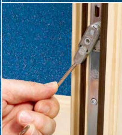
Reversibilità e regolazioni più semplici sull'alza anta falsa manovra. L'orientamento a destra o a sinistra si decide la prima volta con la pressione di un dito, per invertirlo in seguito basta una chiave a brugola. Con una chiave TX si effettuano invece le regolazioni in altezza, più semplici e precise rispetto al sistema "dentini a pettine". Restyling anche nell'aspetto: la vecchia forcella lascia il posto alle forme arrotondate di un cuneo che poggia su perno.
