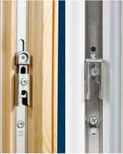
Vita dura per i ladri. Contribuisce alla sicurezza antieffrazione della seconda anta anche un piccolo accorgimento posizionato sull'asta leva. Si tratta di una slitta di bloccaggio, cioè un dispositivo che blocca la maniglia dell'asta leva quando qualcuno cerca di azionarla dall'esterno, come potrebbe fare un eventuale scassinatore.
