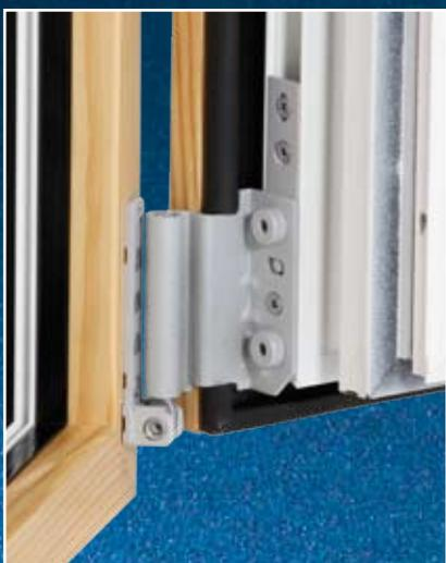
In caso di finestre molto pesanti i meccanismi Multi-Matic si abbinano alla nuova cerniera Maico, in grado di reggere fino a 180 chili. Come la versione per portate fino a 130 chili, anche questa è regolabile sui tre assi. Per incrementare la sicurezza la bandella è saldata alla forbice.
