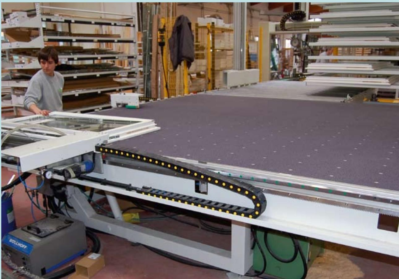
*BA 1525 di Omega per serramenti in legno: la macchina in automatico posiziona l'anta, misura la ferramenta e la posiziona per il taglio. In basso, particolare dell'avvitatore autoalimentato*
