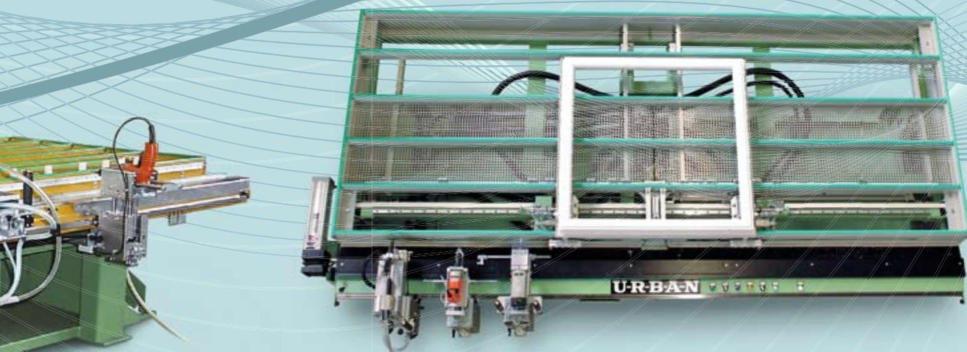
Stazioni di lavoro Urban per PVC, FAS 250 a sinistra e FAS 320 a destra. Il primo modello è un banco manuale che offre già alcune facilitazioni all'operatore, tra cui il caricamento automatico dell'avvitatore. Il secondo è in grado di centrare e bloccare l'anta prima che l'operatore applichi la ferramenta
