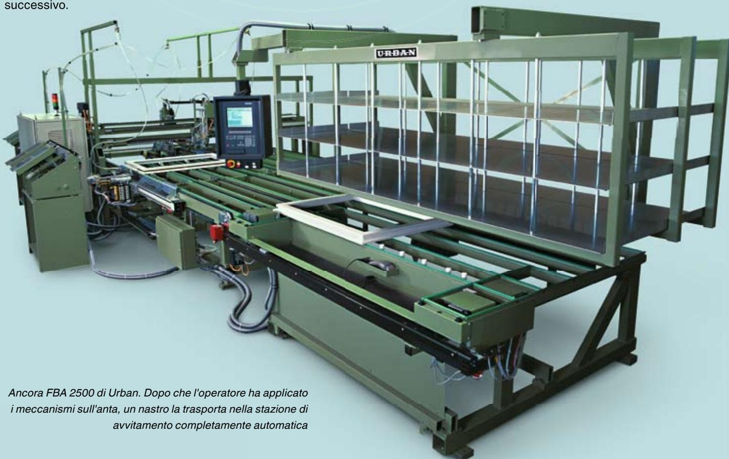
*Ancora FBA 2500 di Urban. Dopo che l'operatore ha applicato i meccanismi sull'anta, un nastro la trasporta nella stazione di avvitamento completamente automatica*
