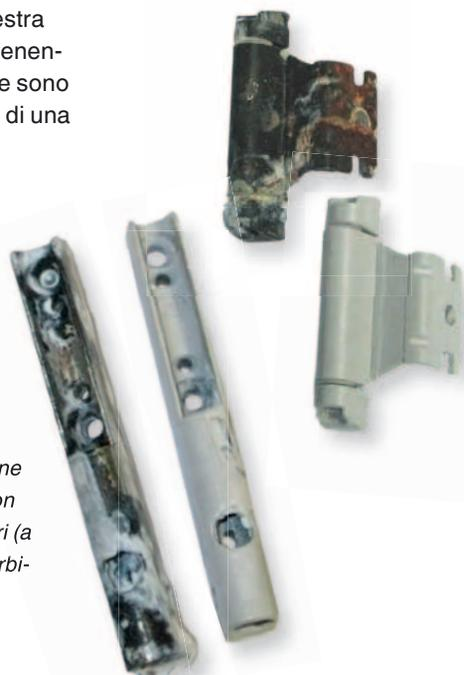
*La diversa resistenza alla corrosione è visibile anche sui pezzi trattati con vernice a polvere: cerniere angolari (a destra quella Tricoat) e supporti fornice (in basso quella Tricoat).*
