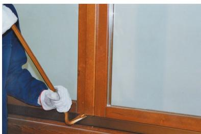
Sui serramenti (porte e finestre) si eseguono prove di permeabilità all'aria, tenuta all'acqua, resistenza al vento, isolamento acustico, calcolo della trasmittanza, prove meccaniche e da gennaio 2002 anche prove di resistenza all'effrazione secondo le nuove norme UNI ENV 1627/2000, UNI ENV 1628/2000, UNI ENV 1629/2000, UNI ENV 1630/2000.
