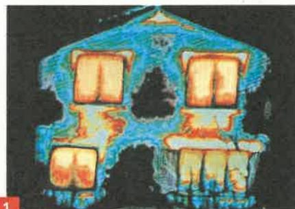
Fig. 1: Le parti chiare mostrano la perdita di calore attraverso finestre, pareti e cassonetti per gli avvolgibili.
